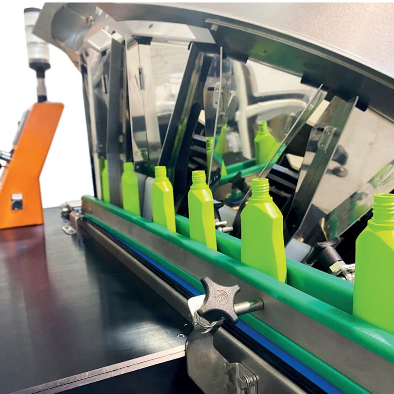
**La série compacte CONTRAK de redresseurs rotatifs pour bouteilles PET, HDPE et PP est spécialement conçue pour des productions jusqu'à 16 000 BPH.**
